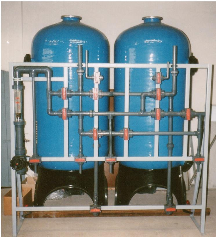
*Sonderanlage zur LHKW-Eliminierung im Rahmen einer Betriebswasseraufbereitung*
