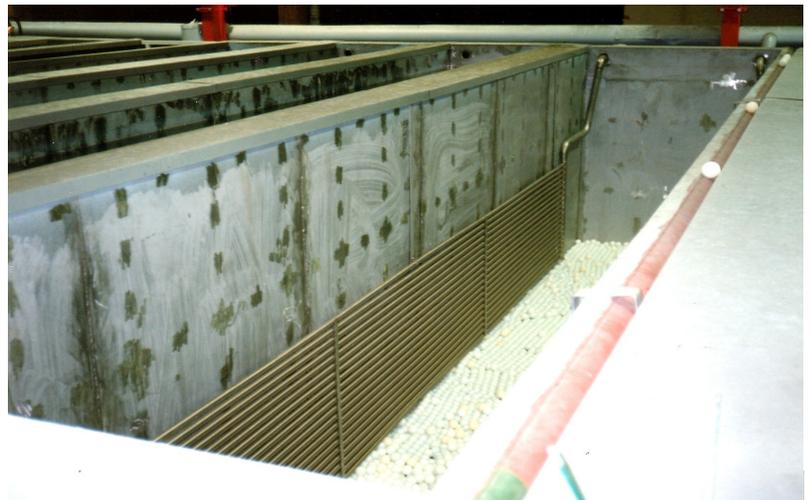
**Abbildungen:** oben: Tauchbehälter für eine Eloxalanlage,
