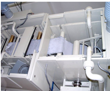
Abbildungen: Versuchsträger zum Testen eines neuen Verfahrens zur Horizontalabscheidung von Bleiband
